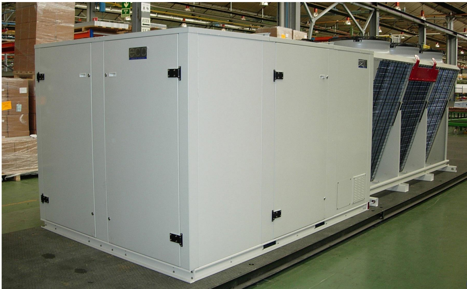
VCC – obudowa skraplacza
